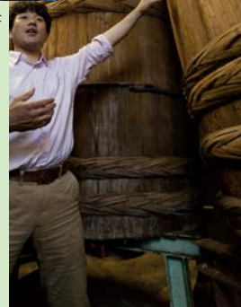
140年以上の木桶もある。たずなをゆるめカンナで修繕しながら使っている。
